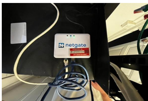
Figure 7 : Photo du routeur Pfsense. Le câble blanc vient de la box internet, le câble bleu va vers le switch général.
